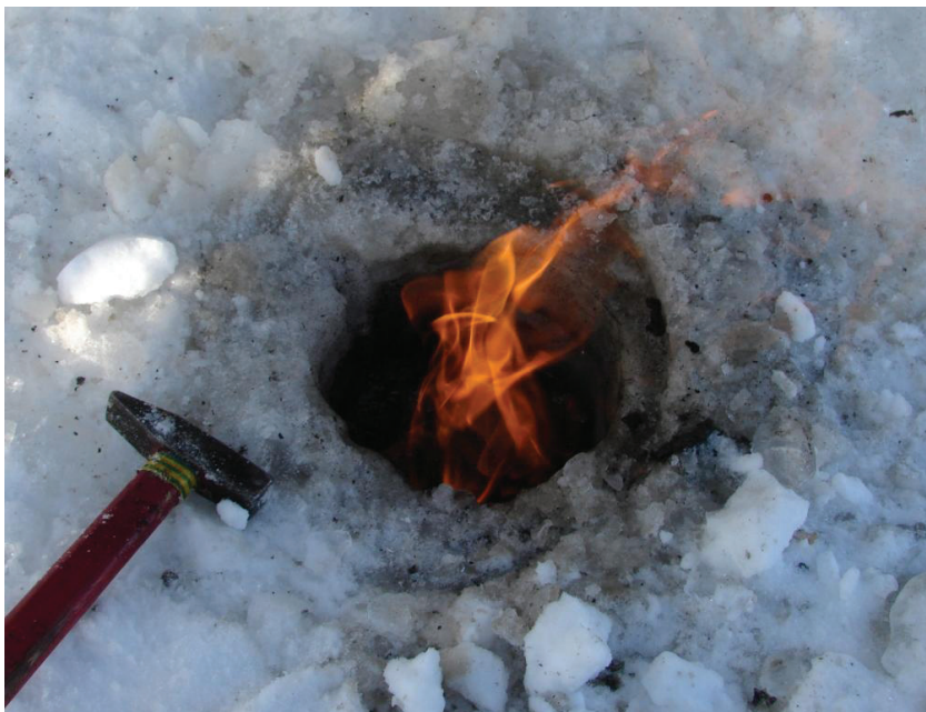
Рис. 3. Длительный выброс метана из скважины 1с-16, поднимающегося из пробуренных талых подрусловых грунтов через толщу речной воды (4,5 м) и речной лед (2 м), апрель 2016 г.
