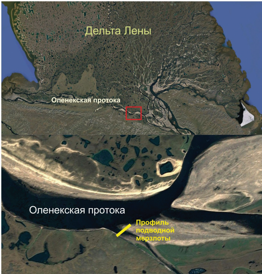
Рис. 6. Профиль через протоку Ысы-Хая-Тебюлеге для исследования кровли подводной мерзлоты, сентябрь 2016 г.
