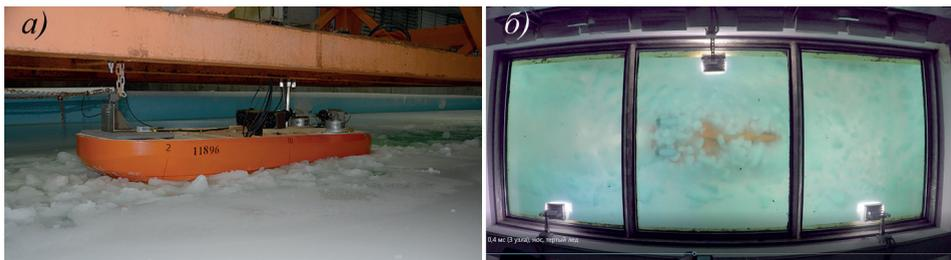
Рис. 2. Испытания модели буксира для порта Сабетта в канале с тертым льдом: *a* — вид сверху; *б* — взаимодействие подводной поверхности буксира с тертым льдом
