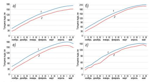
Рис. 3. Подекадное нарастание толщины льда, осредненное по станциям каждого моря за периоды: (1) начало наблюдений — 2004 г. и (2) 2005–2020 гг.: а) Карское море,  $\delta$ ) море Лаптевых,  $\epsilon$ ) Восточно-Сибирское море,  $\epsilon$ ) Чукотское море
