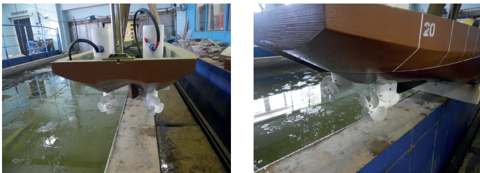
Рис. 4. Двигательный комплекс, установленный на модель НЭС «Иван Фролов»
