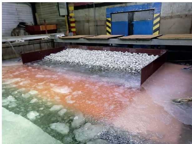
Рис. 8. Модель берегоукрепления с исходным углом откоса 1:4, подготовленная к испытаниям Fig. 8. The model of the bank protection with an initial slope angle of 1:4, prepared for testing
