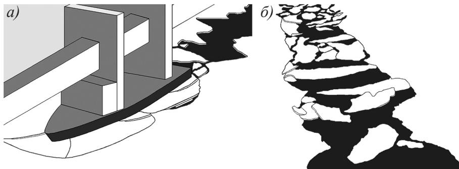
Рис. 2. Прорисовка фотографий экспериментов Л.М. Ногид и его сотрудников, выполненных в 1941 г., по [9, с. 14–15]: *a* — разрушение модельного ледяного покрова носовой оконечностью; *b* — канал, оставшийся после прохождения модели
