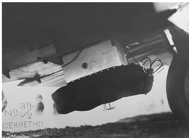
Рис. 5. Крепление ящика с «Кометой» в нижней части самолета перед проведением испытаний по сбрасыванию станции. Сентябрь 1936 г. Рассекречено. ЦГА СПб
