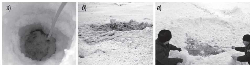
Рис. 1. Эксперимент по взрыву речного льда: а — диаметр до взрыва; б — взрывная майна на расстоянии 6 м; в — измерение диаметра майны после взрыва.
