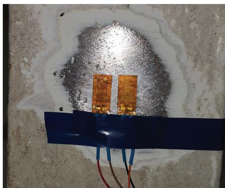
Рис. 5. Пример установки тензодатчика на шпангоуте
