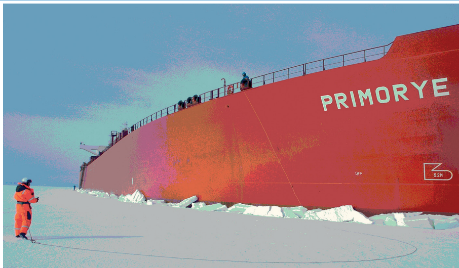
Рис. 5. Характерное разрушение льда при ледовых сжатиях, воздействующих на вертикальный борт цилиндрической вставки. Фото О.Я. Тимофеева
