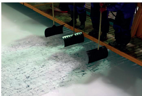
Рис. 4. Процесс приготовления ТЛ в ледовом бассейне [38]
