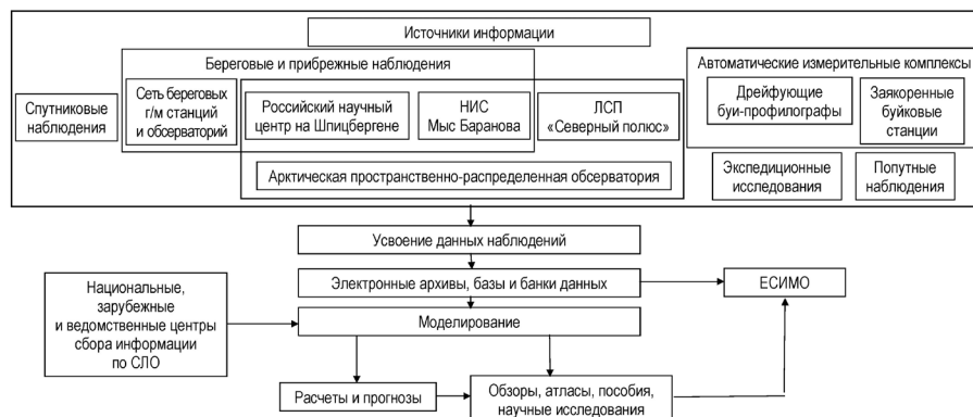
Рис. 3. Схема системы мониторинга ААНИИ гидрологических условий Северного Ледовитого океана Fig. 3. Scheme of the AARI monitoring system for the hydrological conditions of the Arctic Ocean
