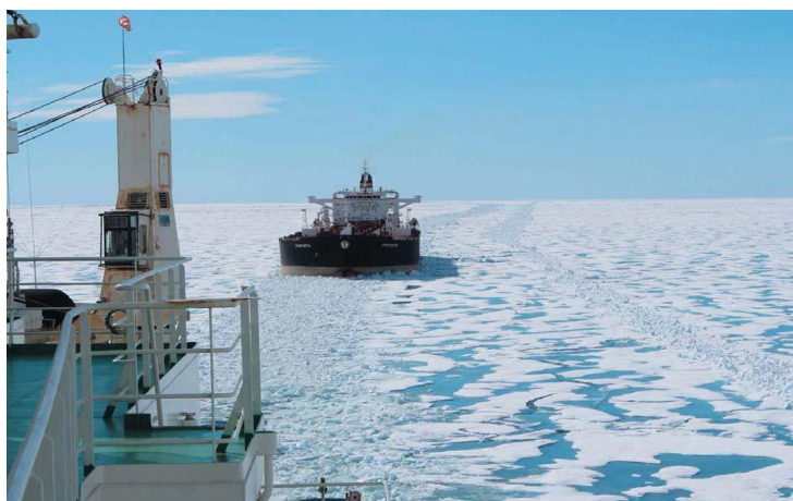
Рис. 1. Проводка танкера «Пропонтис» атомным ледоколом типа «Таймыр» [4]
