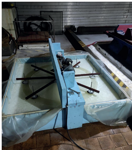
Рис. 10. Установка для проведения испытаний по определению истирающего воздействия льда на образцы материалов
