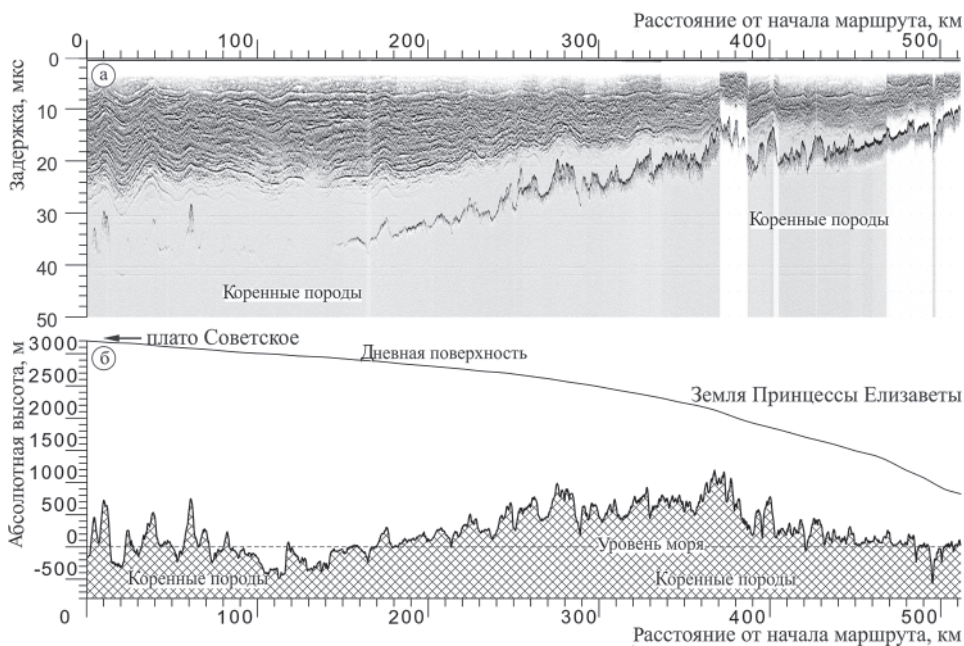
Рис. 3. Временной радиолокационный разрез (а) и разрез ледникового покрова (б) по трассе следования СГП «Прогресс–Восток».
