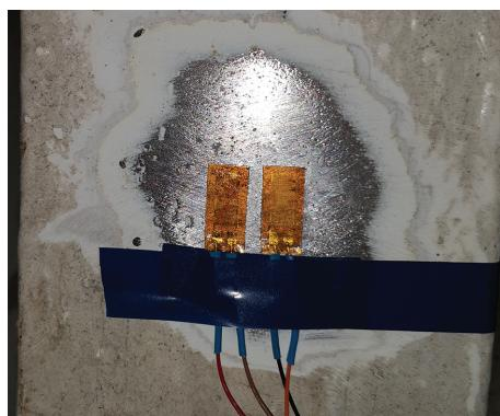
Рис. 5. Пример установки тензодатчика на шпангоуте
